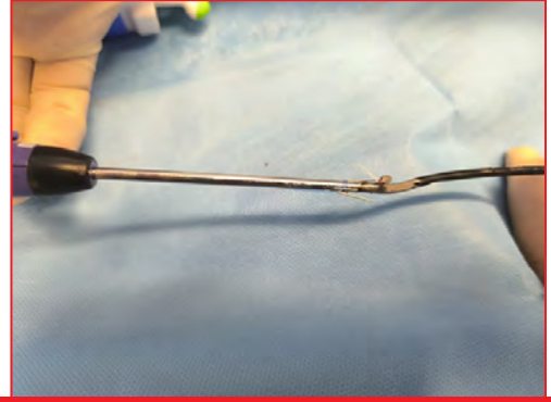
Şekil 2. Kopmuş foot plate parçasının dikiş telleriyle birlikte görünümü.
