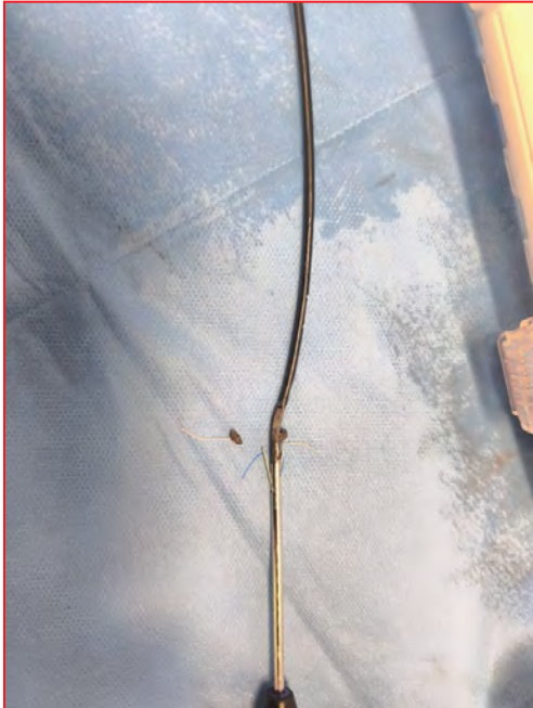
Şekil 1. ProGlide sistemine ait foot plate yapısının deformasyonu ve kopma görünümü.
